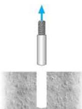
Extração / deslizamento do fixador
