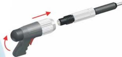
7 Aplicação: Empurre a unidade de disparo contra a de força pra destravar o gatilho. Segure firmemente e acione o gatilho pra ocasionar a deflagração e a introdução da cunha no componente C.
