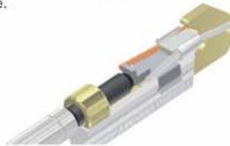
4 Rosqueie a unidade de força ao cabeçote até que sua extremidade encoste no apoio da plataforma de extração que se juntará ao componente C da conexão.
